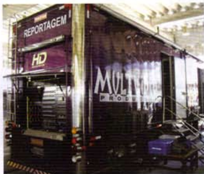
OB Van da Multivideo, equipado para 16 câmeras HD com fibra óptica, esta apto para a realização de grandes eventos no Brasil
